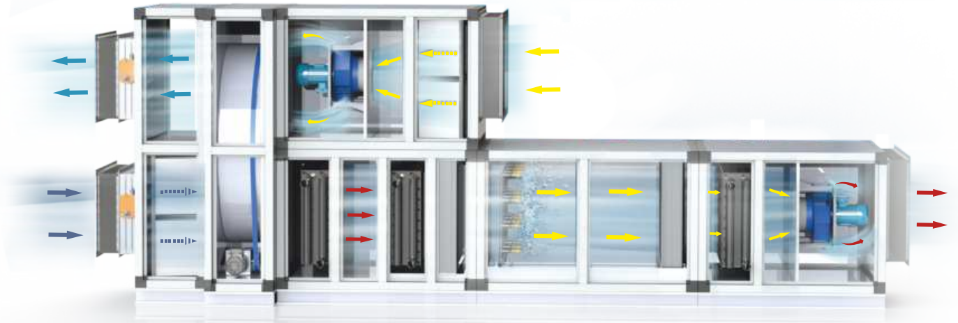
Схема распределения воздуха в центральном кондиционере
